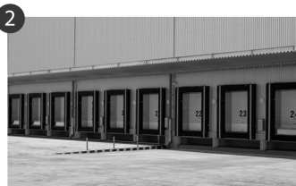
2 ドックシェルター 荷役作業の際の外気・雨風・ 湿気・塵などの侵入を防止
